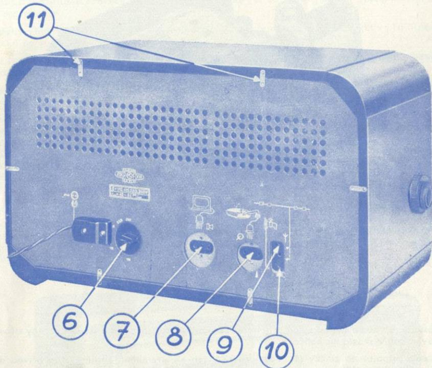
Pootočením uzávěrů (11) uvolněte zadní stěnu a odstraňte ji.
