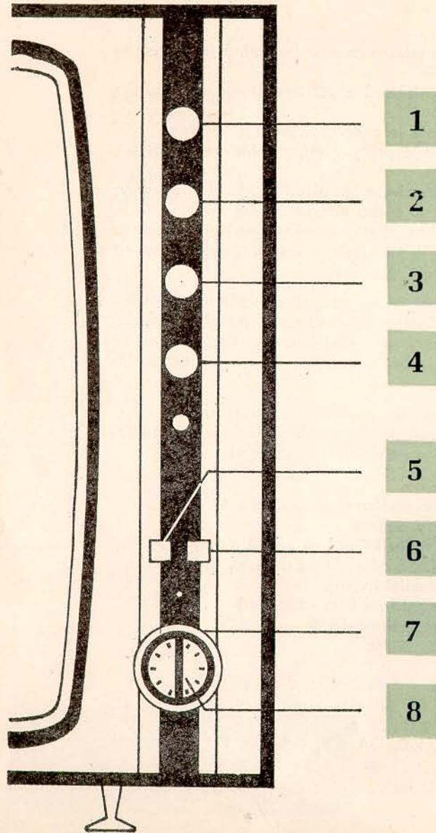
**Sieťový vypínač.** Prijímač zapnete stlačením tlačítka 5. Ďalším stlačením tlačítka prijímač vypnete. Pri zapnutom prijímači ostane tlačítka zatlačené. Pred vypnutím prijímača nestahujte jas, aby ste mali kontrolu, že prijímač je naozaj vypnutý.
