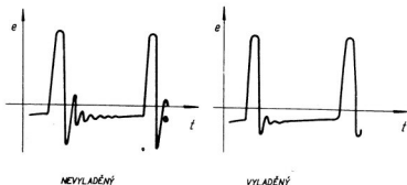
TRANSFORMÁTOR NA 3TÍ HARMONICKOU
